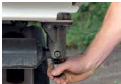
Einhandbedienung der Steckstifte an den neuen Kugelkippteilen
